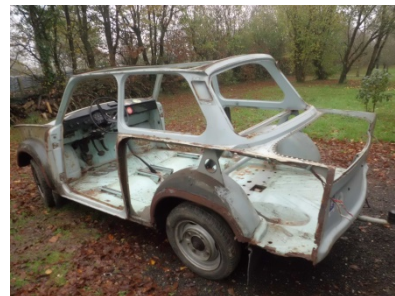
Dénudée, laissant apparaître les taches de rouille
